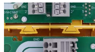
Plusieurs appareils peuvent être connectés en série à l'aide de la technologie enfichable du boîtier (DBX TC B 180).
