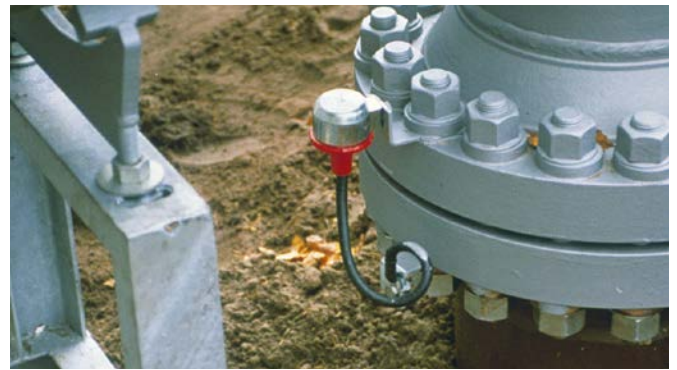
Eclateur de ligne certifié ATEX destiné à l'équilibrage de potentiel pour la protection contre la foudre selon CEI 62305 et NF EN 62305 avec basse tension d'amorçage.
