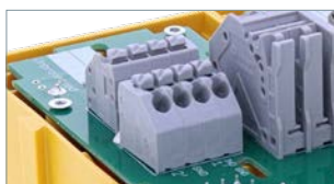
Bornes pour une connexion rapide sans outils (DBX TC B 180)
