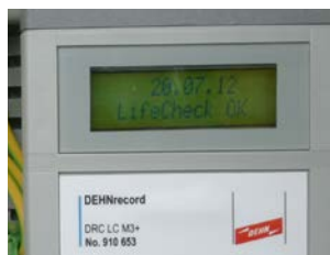
Test en intervalles avec le DRC LC M3+.
